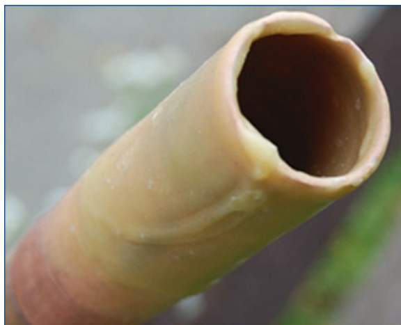
Figure 14 : Foret tubulaire expérimental en cuivre enduit de cire
