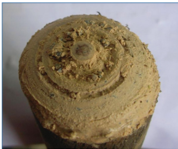
Figure 15 : Extrémité d'une mèche de foret pleine, expérimentale, en bois
