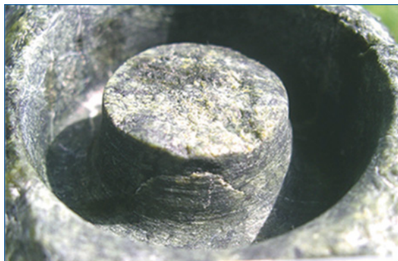
Figure 13 : Exemple de carotte de forage expérimentale se formant au centre du forage tubulaire
