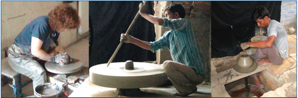
Figure 3 : Les tours utilisés dans les trois contextes culturels. De gauche à droite : le tour électrique (activé par une pédale) utilisé par les potiers français, le tour-toupie utilisé par les potiers Prajapati et le tour-à-pied utilisé par les potiers Multani.
